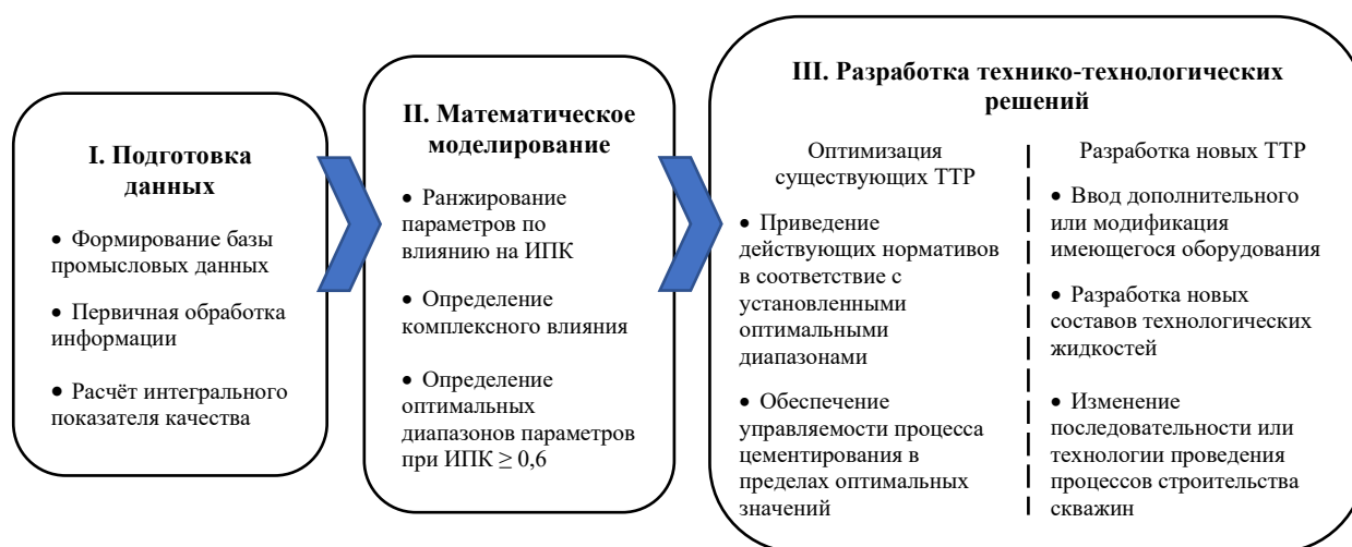
Рисунок 3 – Принципиальная схема методики разработки технико-технологических решений
