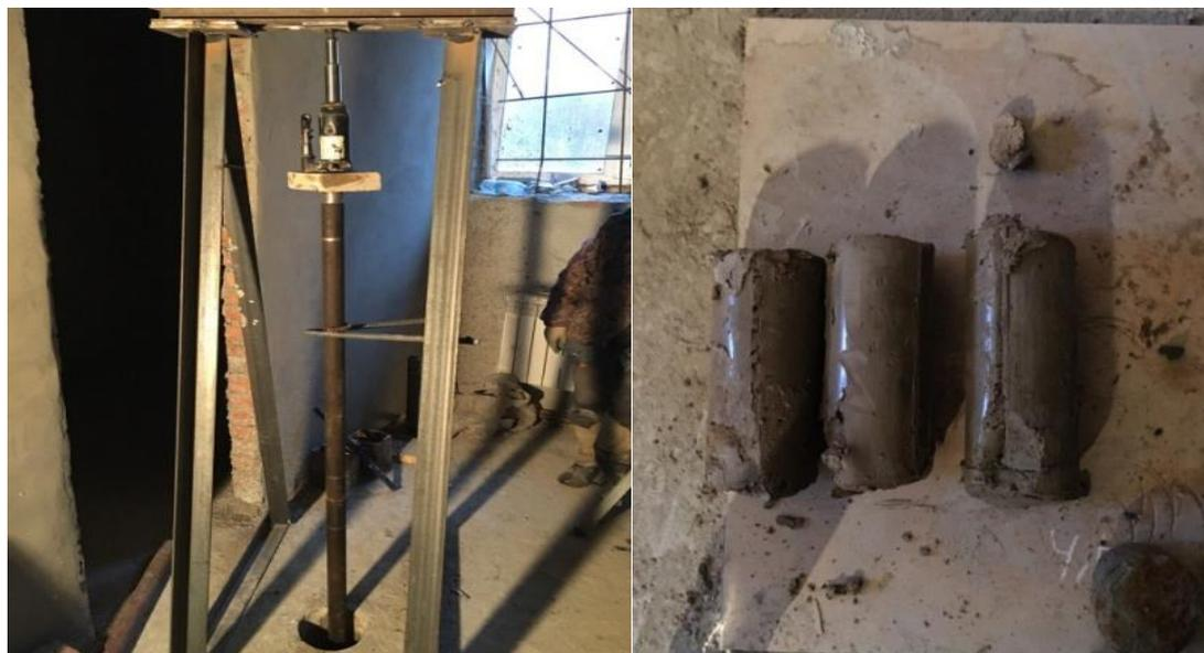
**Рисунок 4.3** – Отбор проб грунта из контура фундаментной плиты
