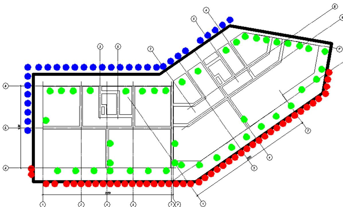
**Рисунок 4.10** – План фундаментной плиты с расположением на нем скважин и инъекторов (синий цвет – этап I: закрепление основания; красный цвет – этап II: выбуривание грунта; зеленый цвет – этап III: закрепление основания по периметру)
