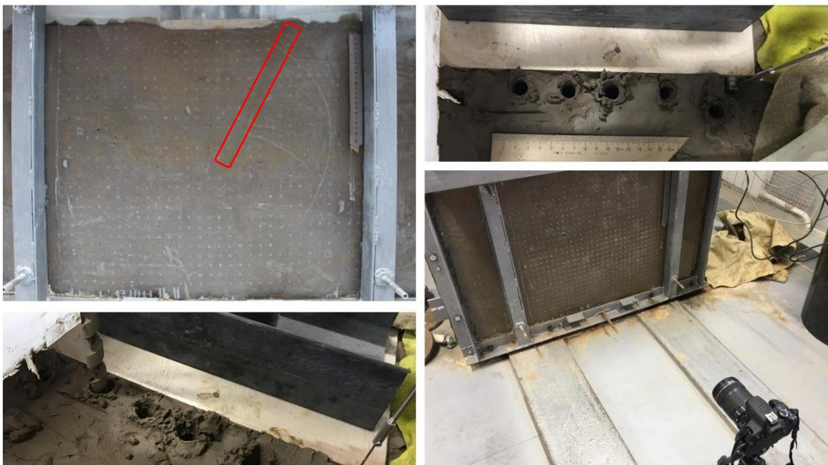
**Рисунок 2.12** – Экспериментальная установка и процесс выбуривания наклонных скважин
