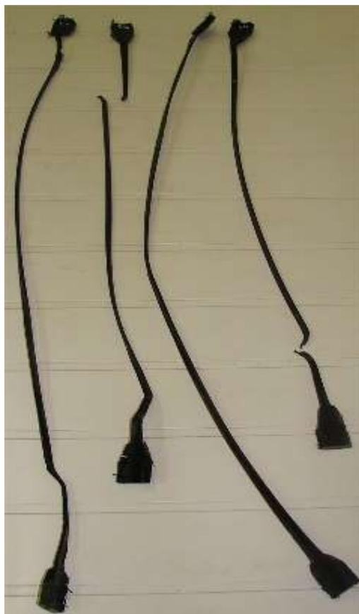
Рисунок 2.2.4 – Образцы-лопатки МПАТ (после испытаний)
