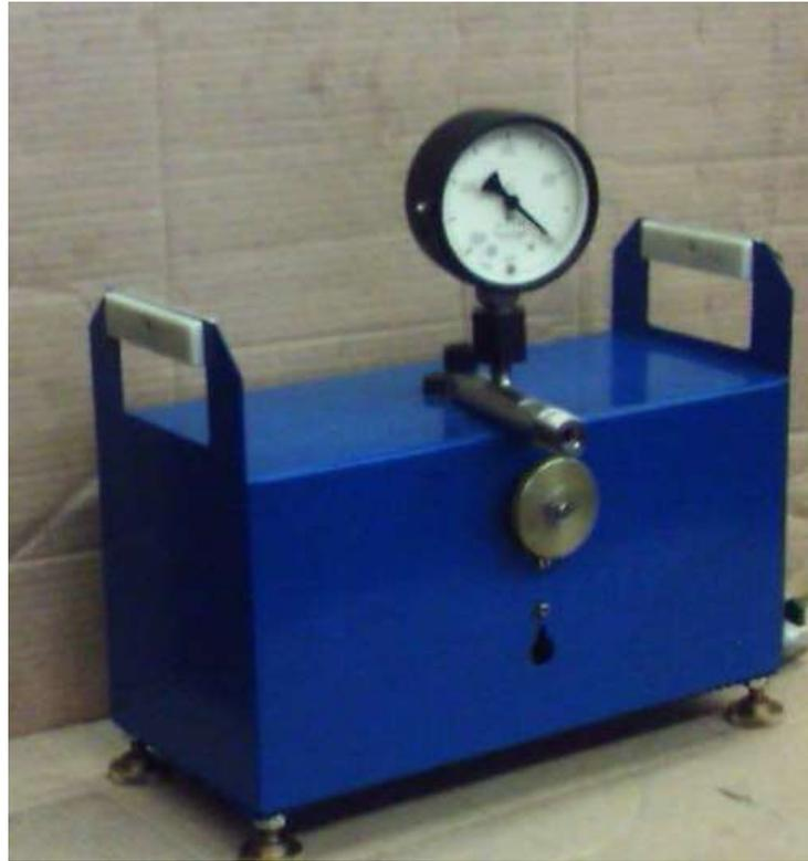
Рисунок 2.3.1 – Пневмогидравлическая насосная станция ПГН-500К с образцовым манометром
