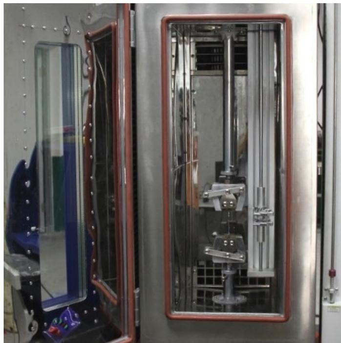
Рисунок 2.2.2 - Низкотемпературная камера разрывной машины МТ-130К-О
