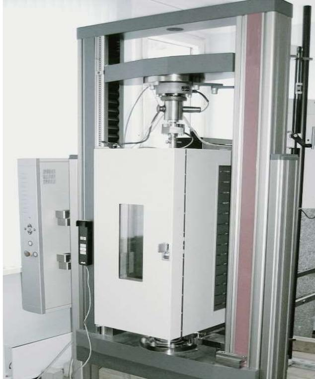
Рисунок 2.2.1 - Разрывная машина МТ-130К-О с низкотемпературной камерой
