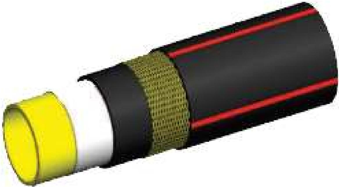
Рисунок 1.5.5 – Гибкая полимерная труба с многослойным лайнером производства ООО «ПОЛИМАК»
