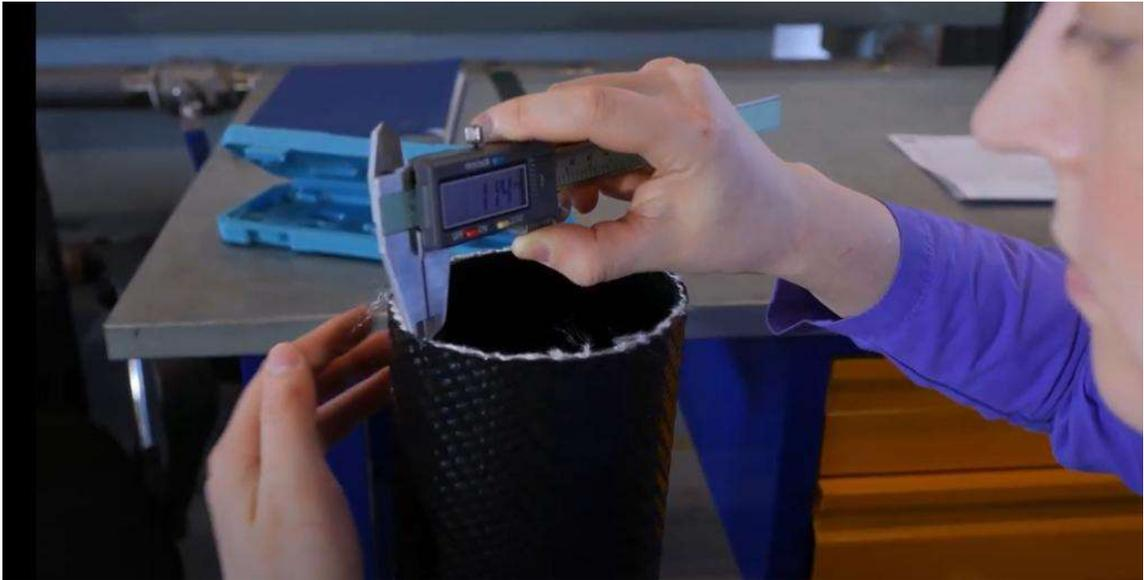
Рисунок 1.5.1 – Контроль толщины стенки плоскостворачиваемого рукава
