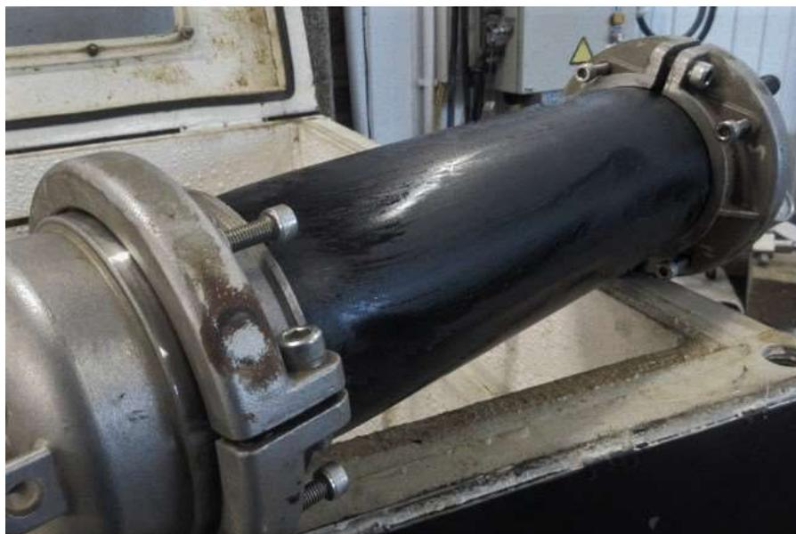
Рисунок 2.3.2 – Образец-катушка МПАТ с концевыми заглушками
