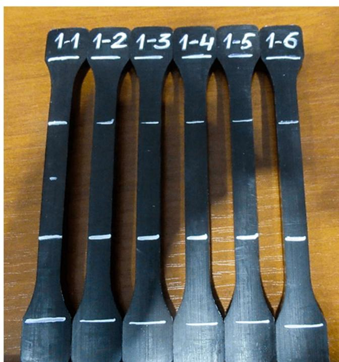
Рисунок 2.2.3 - Образцы-лопатки МПАТ (до испытаний)
