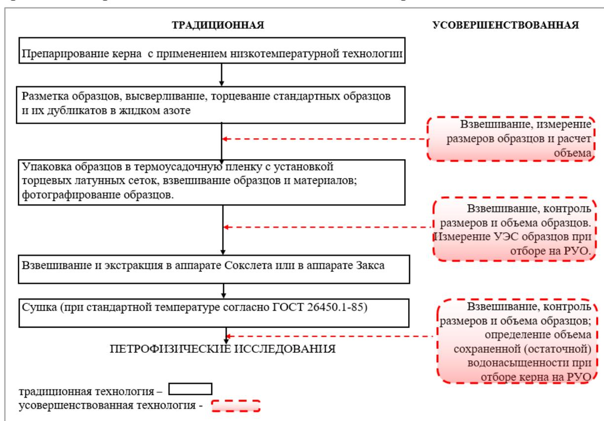
Рисунок 2 – Усовершенствованная технология подготовки образцов слабосцементированного керна для исследований
