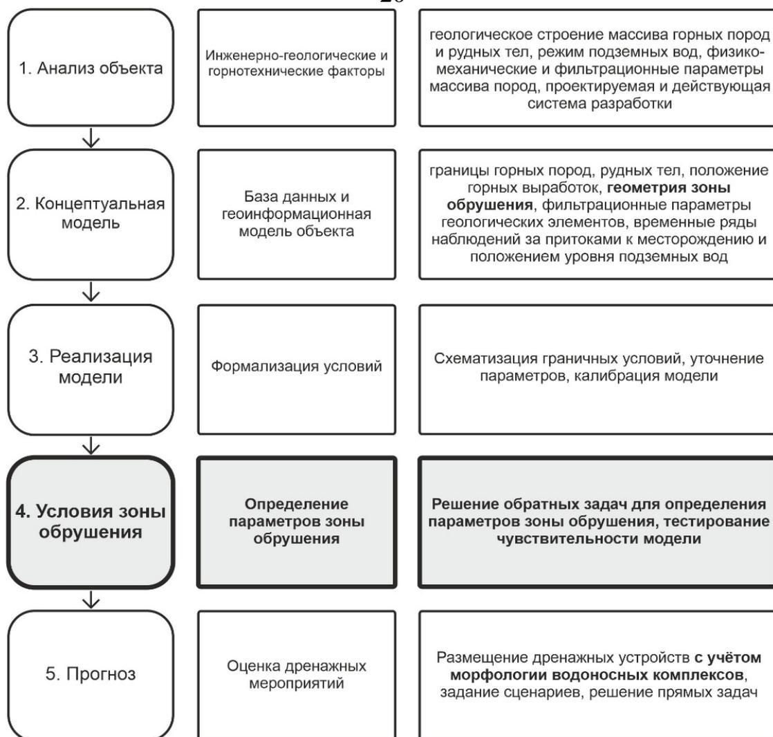
Рисунок 7 – Методика обоснования дренажа дезинтегрированного массива зоны обрушения.
