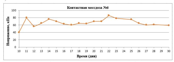
**Рисунок. 4.33.** График изменения напряжений в контактной зоне «фундамент – грунт» с учетом последующей релаксации напряжений ( $p_{uem} = 0,4\text{-}0,6 \text{ M}\Pi a$ )
