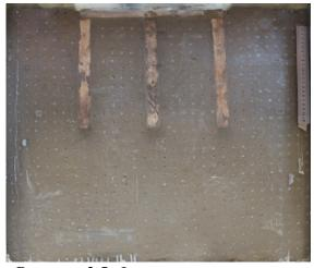
**Рисунок 2.5.** Фото основания плитносвайного фундамента при нагрузке N=10кН  $(p_{cp}=111\ \mathrm{k\Pi a})$
