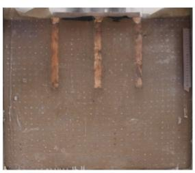
Рисунок 2.6. Фото основания плитносвайного фундамента с опрессовкой при нагрузке N=10кН ( $p_{cp}=111$  кПа)
