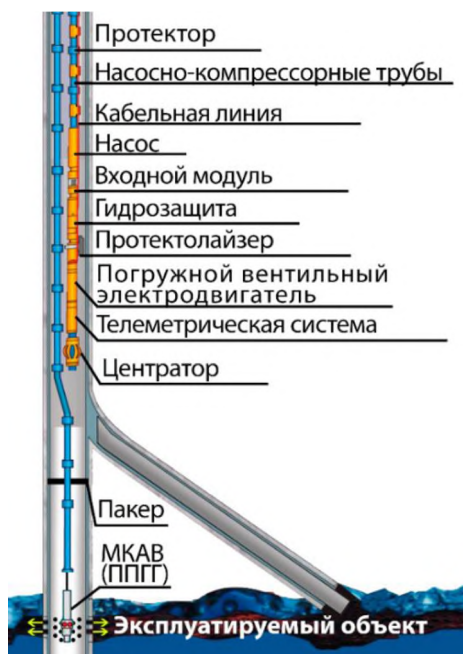
Рисунок 1 – Вариант обустройства скважины с дуальной системой стволов
