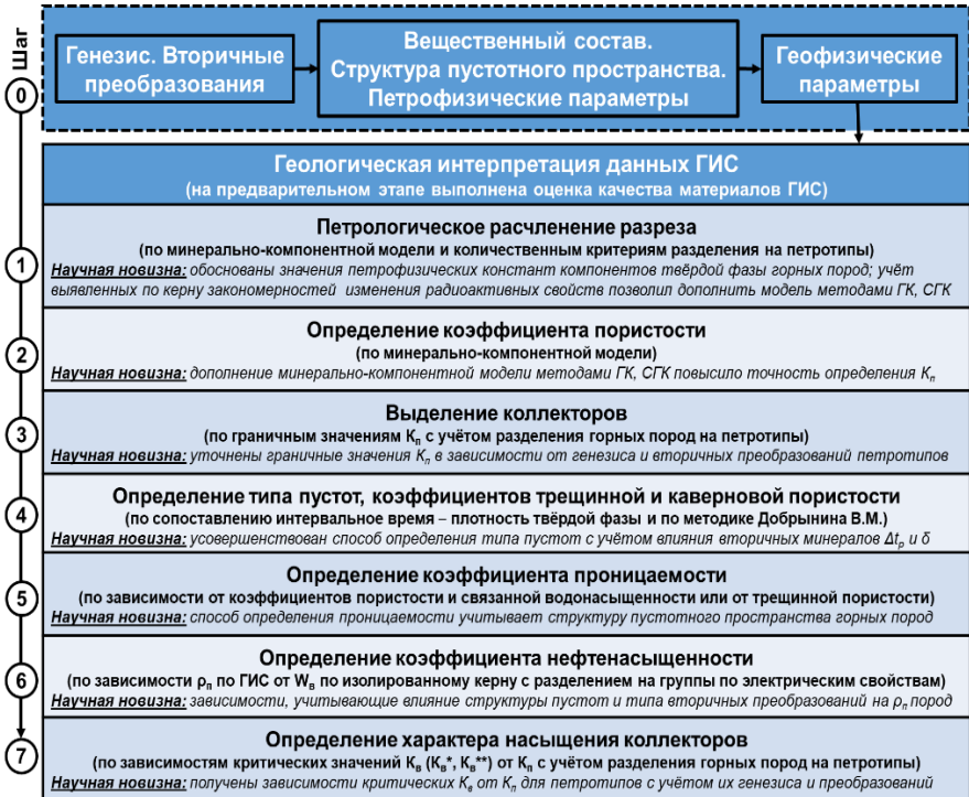
Рисунок 12 – Блок-схема геологической интерпретации данных ГИС в разрезах вулканических формаций (на примере целевого объекта)
