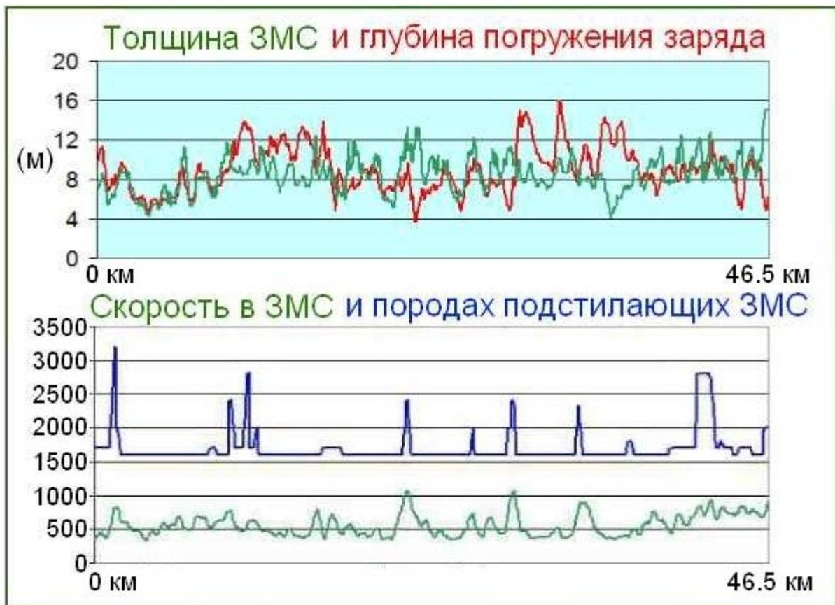
**Рисунок 5.12.** Построенная на основе реальных данных (работы по технологии многоуровневой сейсморазведки на Северо-Часельской площади 1997-1999 гг.) модель условий возбуждения волн
