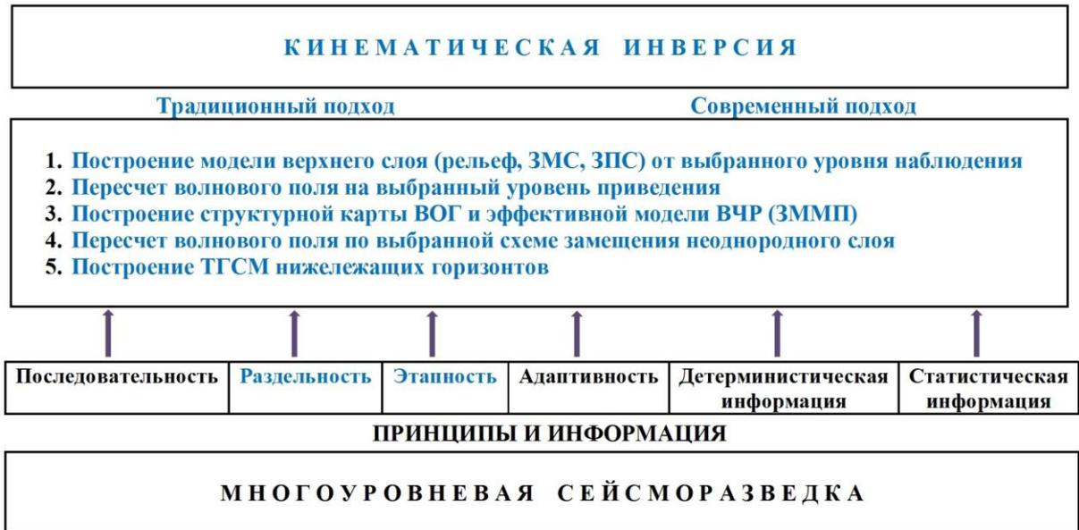
**Рисунок 2.21.а.** Краткая методическая блок-схема реализации кинематической инверсии
