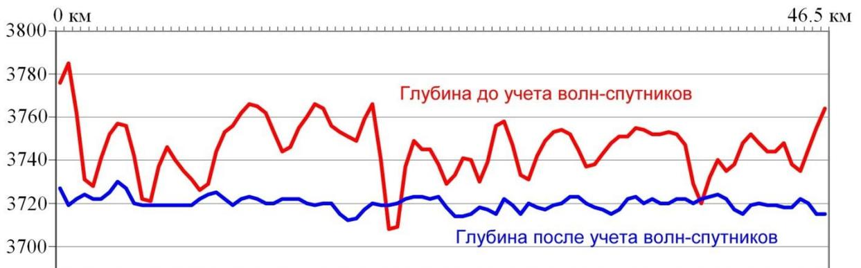
**Рисунок 5.18.** Графики сейсмических глубин  $H = t_o * V_{огт} / 2$  (граница № 9) до и после учета волн-спутников.
