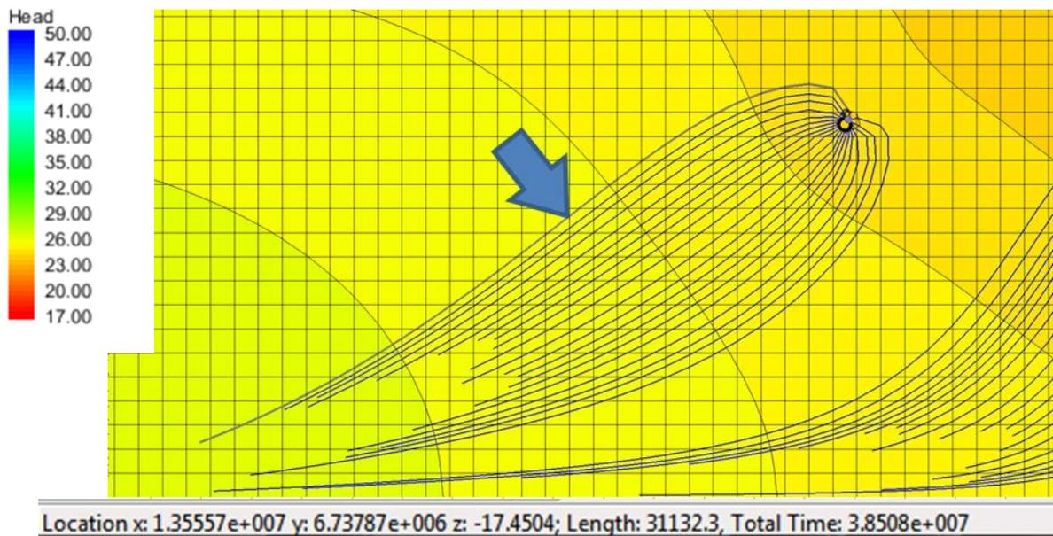
Рисунок 2.45 – Параметры выделенной (показана стрелкой) линии тока: локализация в пространстве, длина ( $\sim 31$  км) и время движения частицы жидкости вдоль показанной траектории ( $3,85 \times 10^7$  сут или 105 тыс лет)
