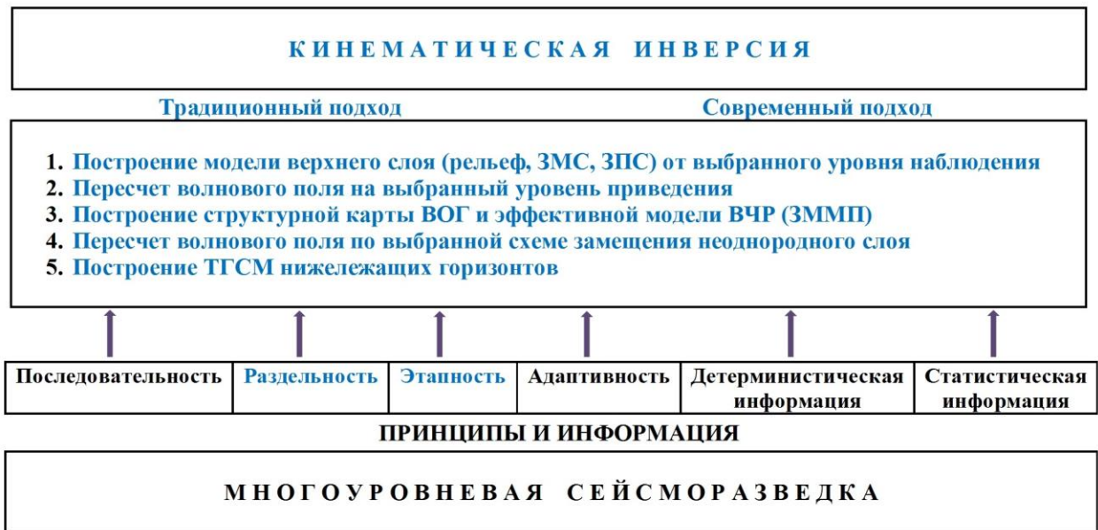
Рисунок 7 - Краткая методическая блок-схема реализации кинематической инверсии
