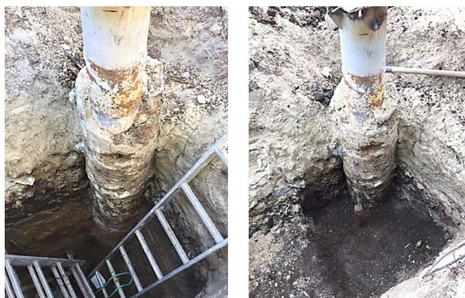
**Рисунок 3.19.** «Грунтовая рубашка» по периметру стволов опытных свай при поярусной откопке.
