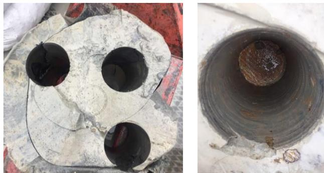
**Рисунок 3.25.** Отбор кернов из тела опытных буроинъекционных свай.
