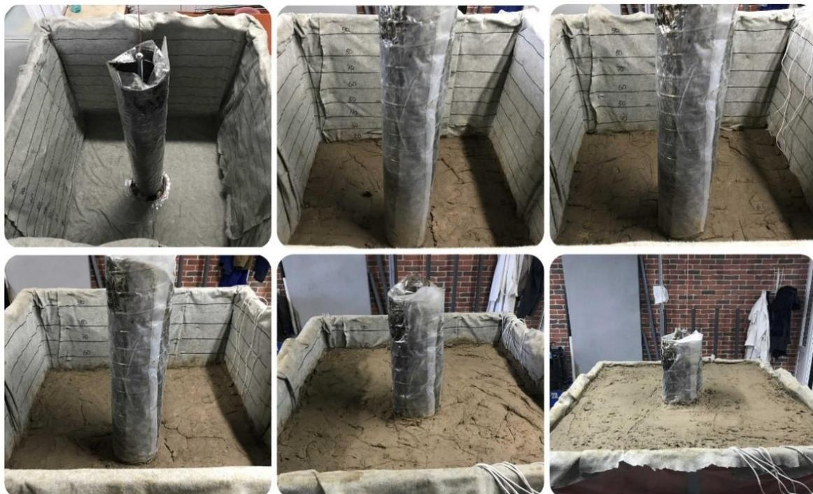
**Рисунок 2.5.** Процесс послойного заполнения экспериментального лотка грунтом.
