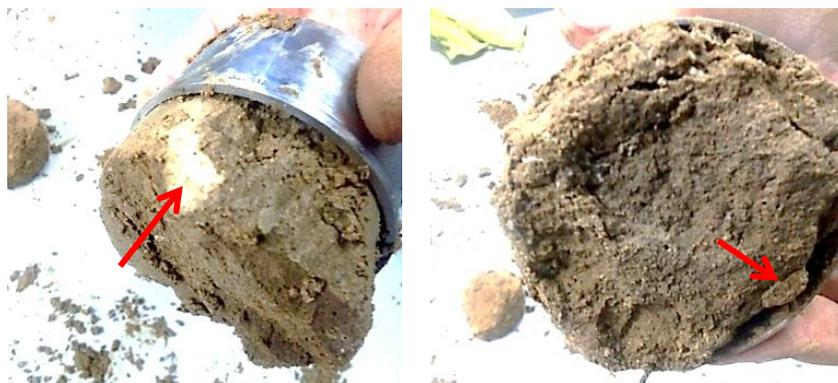
**Рисунок 3.17.** Включения цементного камня в грунт в пределах режущего кольца №1.
