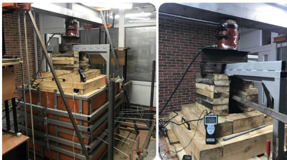
**Рисунок 2.10.** Процесс испытания фрагмента сваи статической вдавливающей нагрузкой.
