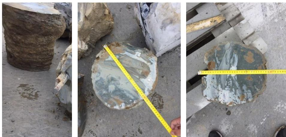
**Рисунок 3.21.** Уширения ствола анкерной сваи.
