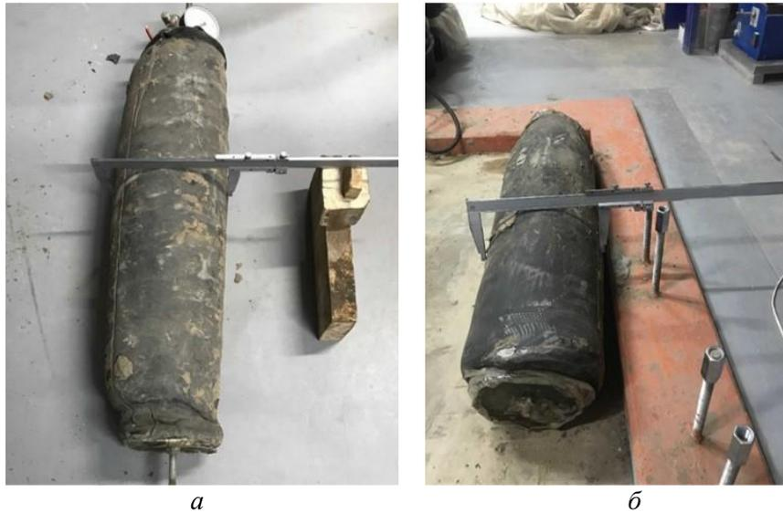
**Рисунок 2.18.** Измерение диаметра свай при  $p_{опр}=85-100$  кПа:
