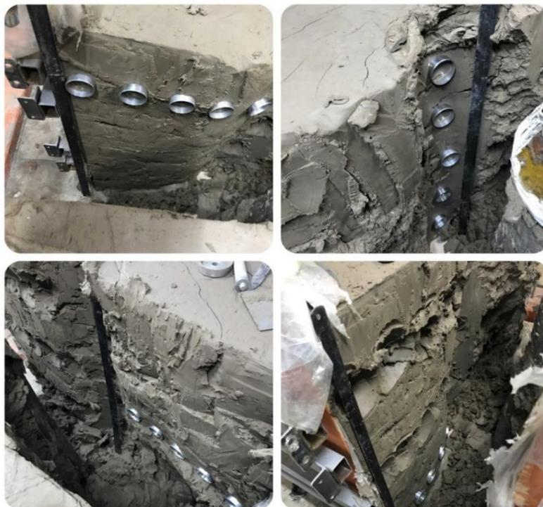
**Рисунок 2.11.** Схема отбора образцов грунта после проведения испытаний.
