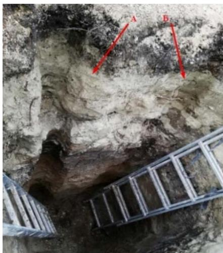
**Рисунок 3.16.** Поярусный отбор проб грунта в естественном состоянии из шурфа.
