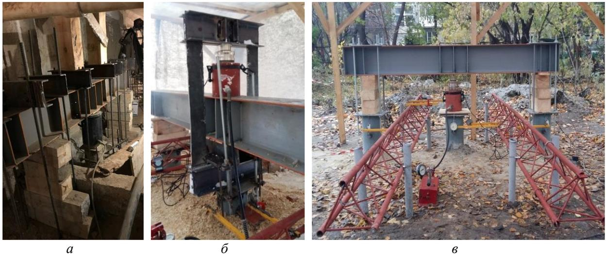
**Рисунок 3.10.** Установки для испытания грунтов сваями: *а* – на действие статической вдавливающей нагрузки (площадка №2), *б, в* – на действие статической выдергивающей и вдавливающей нагрузки (площадка №1).
