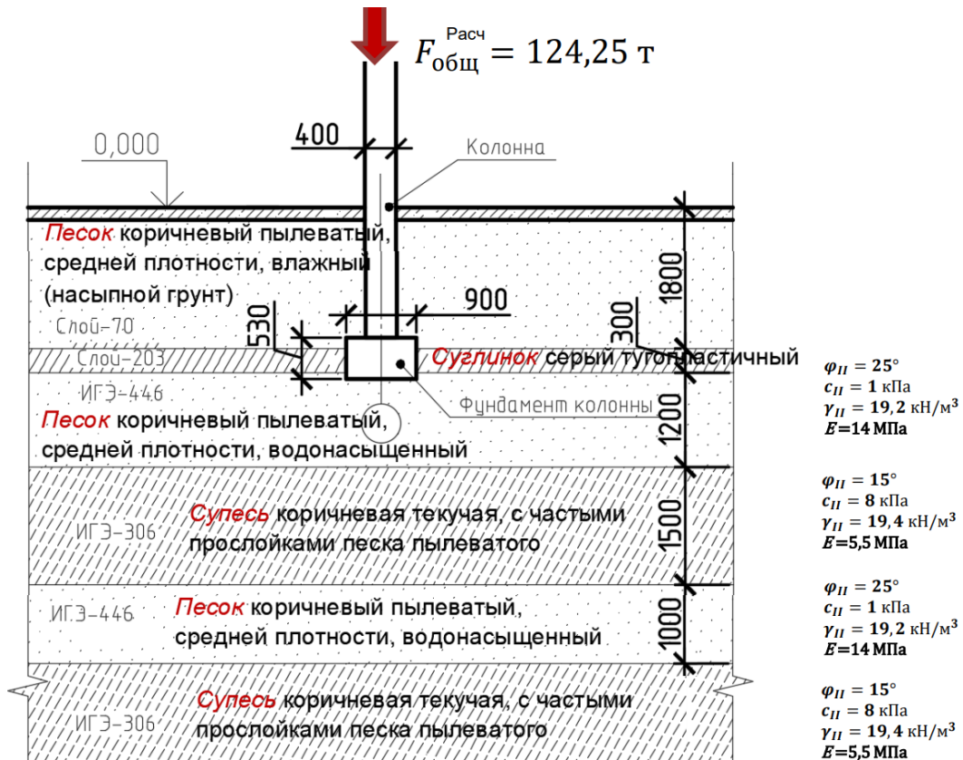
Рисунок 5.11 – Геологический разрез с информацией о характеристиках грунтов
