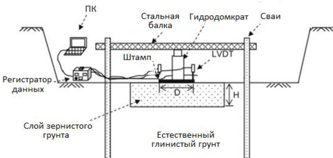
Рисунок 4.22 – Схема испытательной установки
