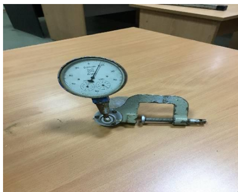
Рисунок 4.11. Индикатор часового типа 6-ПАО
