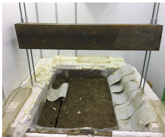
Рисунок 4.30. Устройство водонепроницаемой геомембраны в нижней части земполотна
