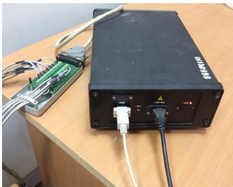
Рисунок 4.2. Измеритель теплопроводности многоканальный ИТ-2-48
