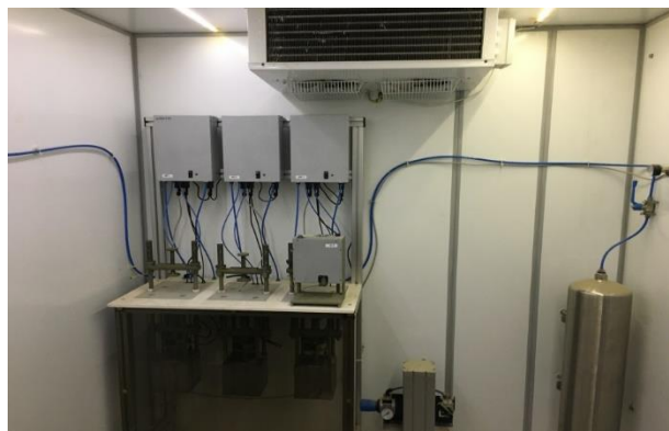
Рисунок 4.6. Приборы для определения механических свойств многолетнемерзлых грунтов
