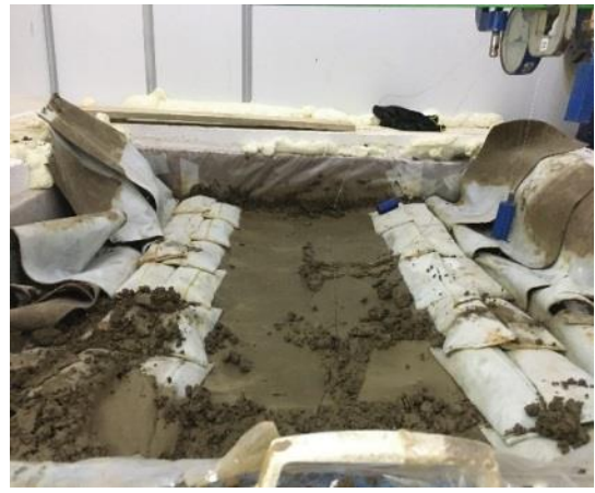
Рисунок 4.37. Талый слой основания под основной площадкой земполотна при воздействии неглубоких водоемов с КТМ
