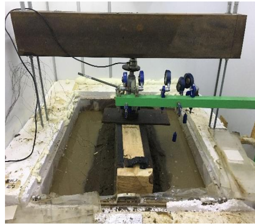
Рисунок 4.27. Общий вид лотка второй серии экспериментальных исследований с моделированием подтока воды
