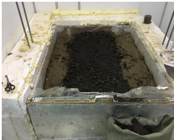
Рисунок 4.19. Устройство фильтрационной прослойки на границе «основание-земполотно»
