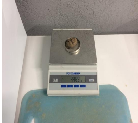
Рисунок 4.10. Лабораторные весы Госметр ВЛТЭ-210/510С
