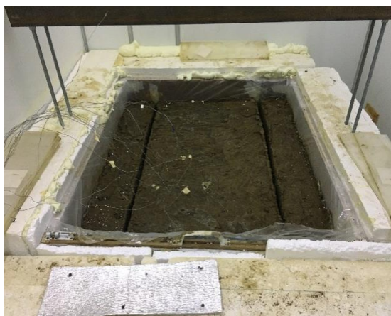
Рисунок 4.29. Разработка траншей для размещения водонепроницаемой геомембраны в нижней части земполотна
