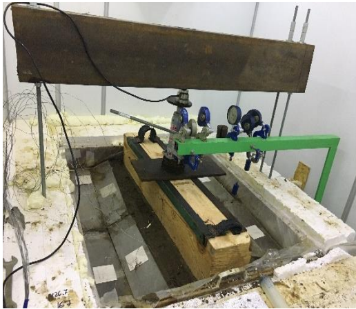
Рисунок 4.26. Общий вид лотка второй серии экспериментальных исследований с моделированием снежного покрова
