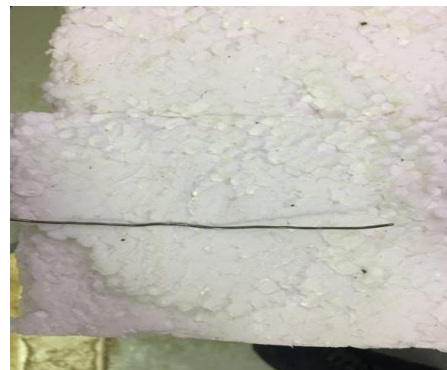
Рисунок 4.3. Термоэлектрические хромель-копелевые преобразователи (термопара) типа L
