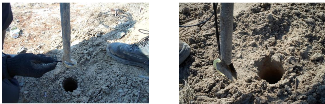
Рисунок 2.30. Способ погружения мессдоз в грунт
