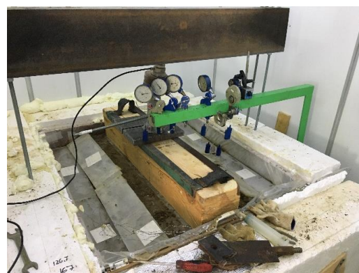
Рисунок 4.34. Общий вид экспериментального стенда моделируемого земполотна и основания автомобильной дороги на ММГ в период промерзания
