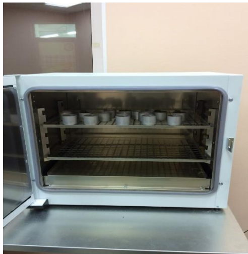
Рисунок 4.14. Высушивание грунта в сушильном шкафу до воздушно-сухого состояния
