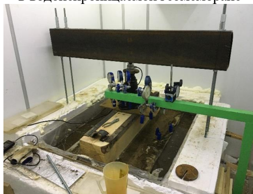
Рисунок 4.33. Общий вид экспериментального стенда моделируемого земполотна и основания автомобильной дороги на ММГ в период оттаивания
