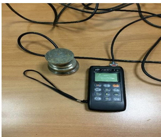
Рисунок 4.9. Электронный динамометр «Дин-1»
