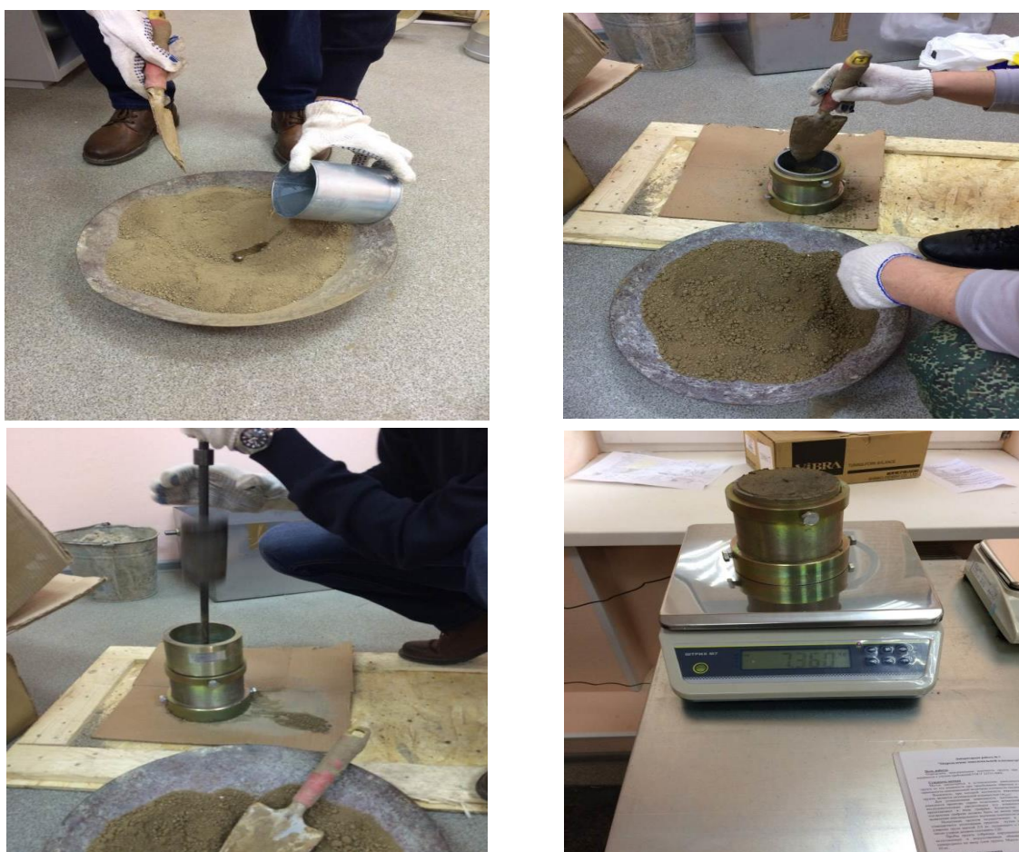
Рисунок 4.17. Определение максимальной плотности и оптимальной влажности грунта
