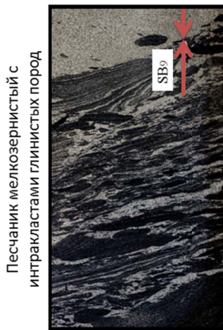
Рис. 43. Выделение эрозионной поверхности в интервале пластов покурской свиты по данным кернового материала.
