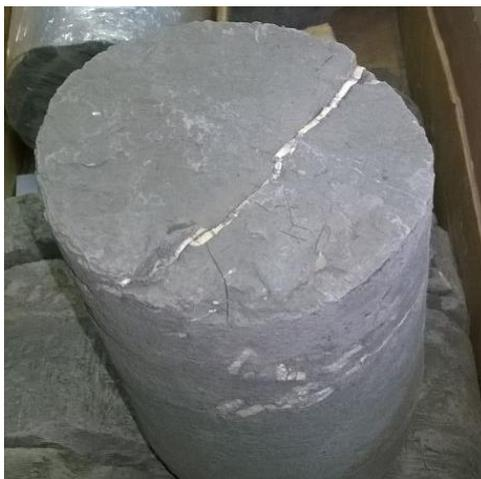
Рисунок - 2.13 Залеченная макротрещина в керне
