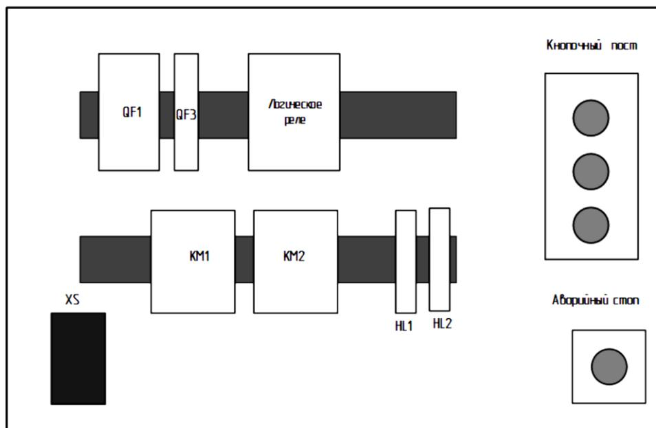
Рисунок 1- Схема компоновки электроустановки
