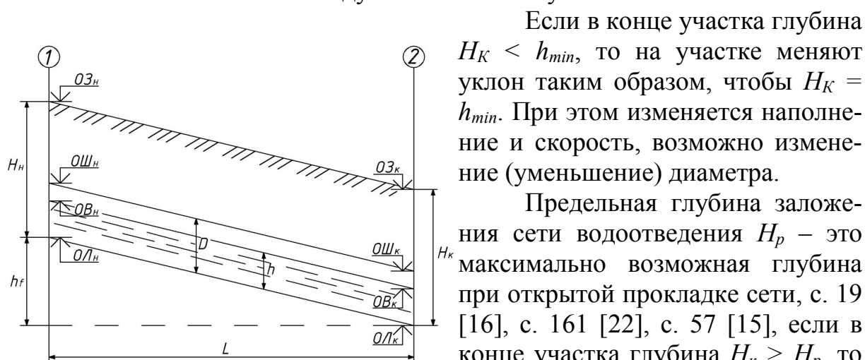
Рис. 2.2. Рабочая схема для гидравлического расчета участка коллектора
