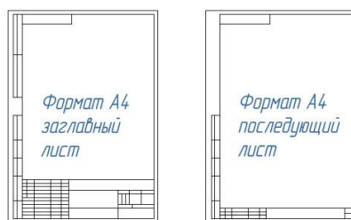
Рисунок 1 – размещение основной надписи на листе А4 пояснительной записки дипломного проекта
