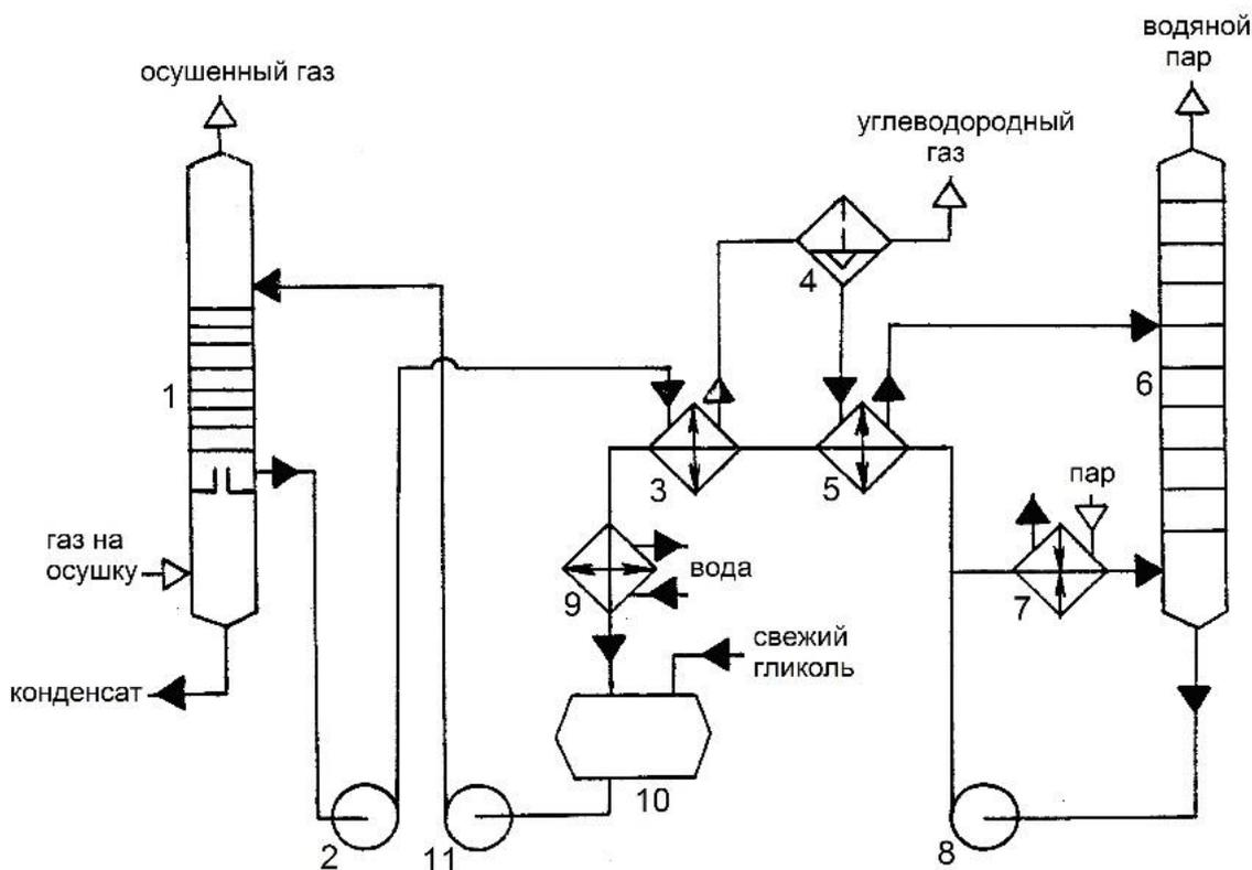
1 – абсорбер; 2, 8, 11 – насосы; 3, 5 – теплообменники; 4 – сепаратор;
