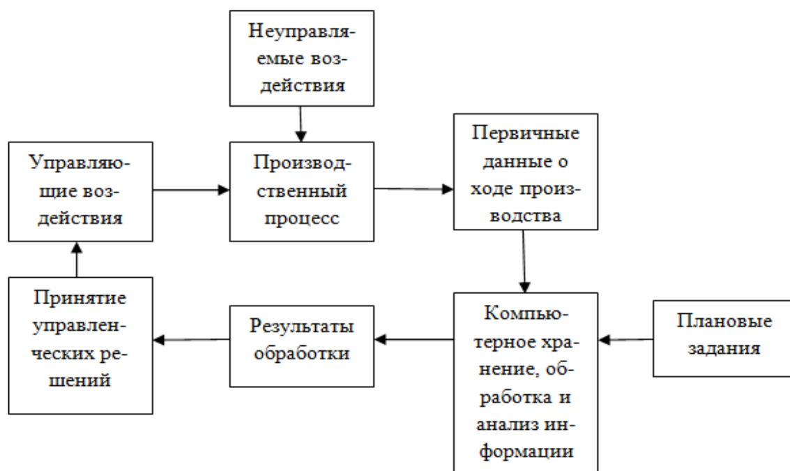
Рис. 1.5 Схема компьютерного управления производственным процессом
