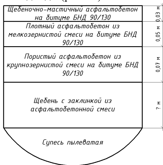
Рис. 3.1 – Конструктивная схема дорожной одежды
