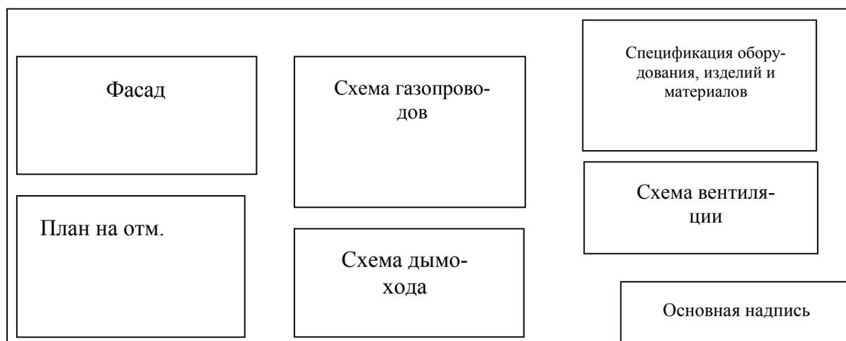
Рисунок 5 - Расположение схем и чертежей на листе 2
