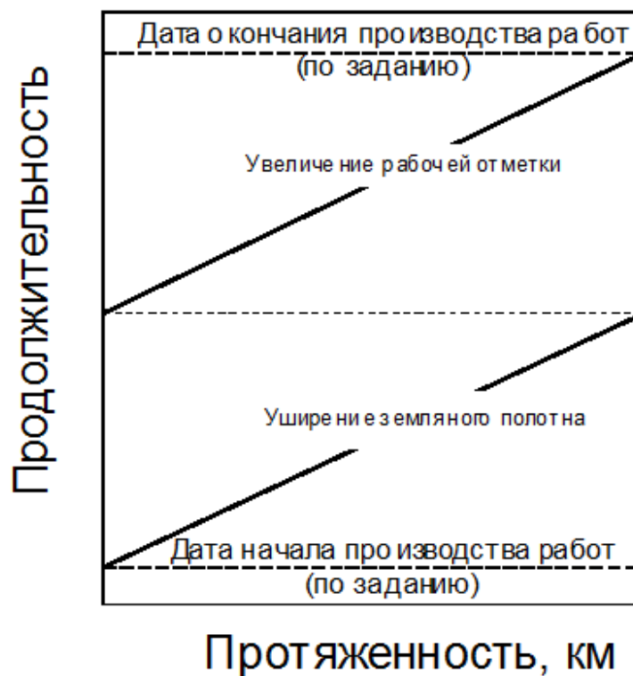
Рисунок 6.2 – Последовательная организация работ с соединением потоков по уширению в один
