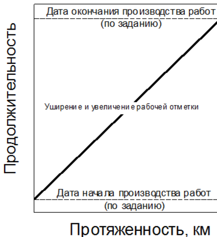
Рисунок 6.3 – Организация работ одним потоком
