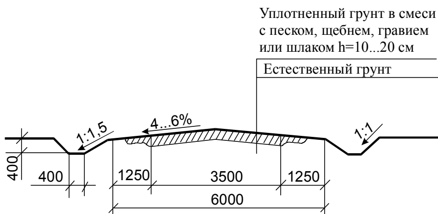
Рис. 7.1. Профиль временной грунтовой дороги с улучшенным покрытием
