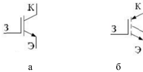
Рисунок 5.13 – Условное графическое изображение IGBT транзистора: отечественное (а) и зарубежное (б)
