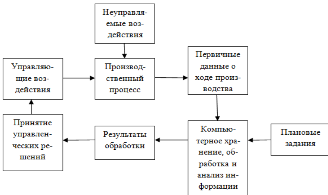
Рис. 1.5 Схема компьютерного управления производственным процессом
