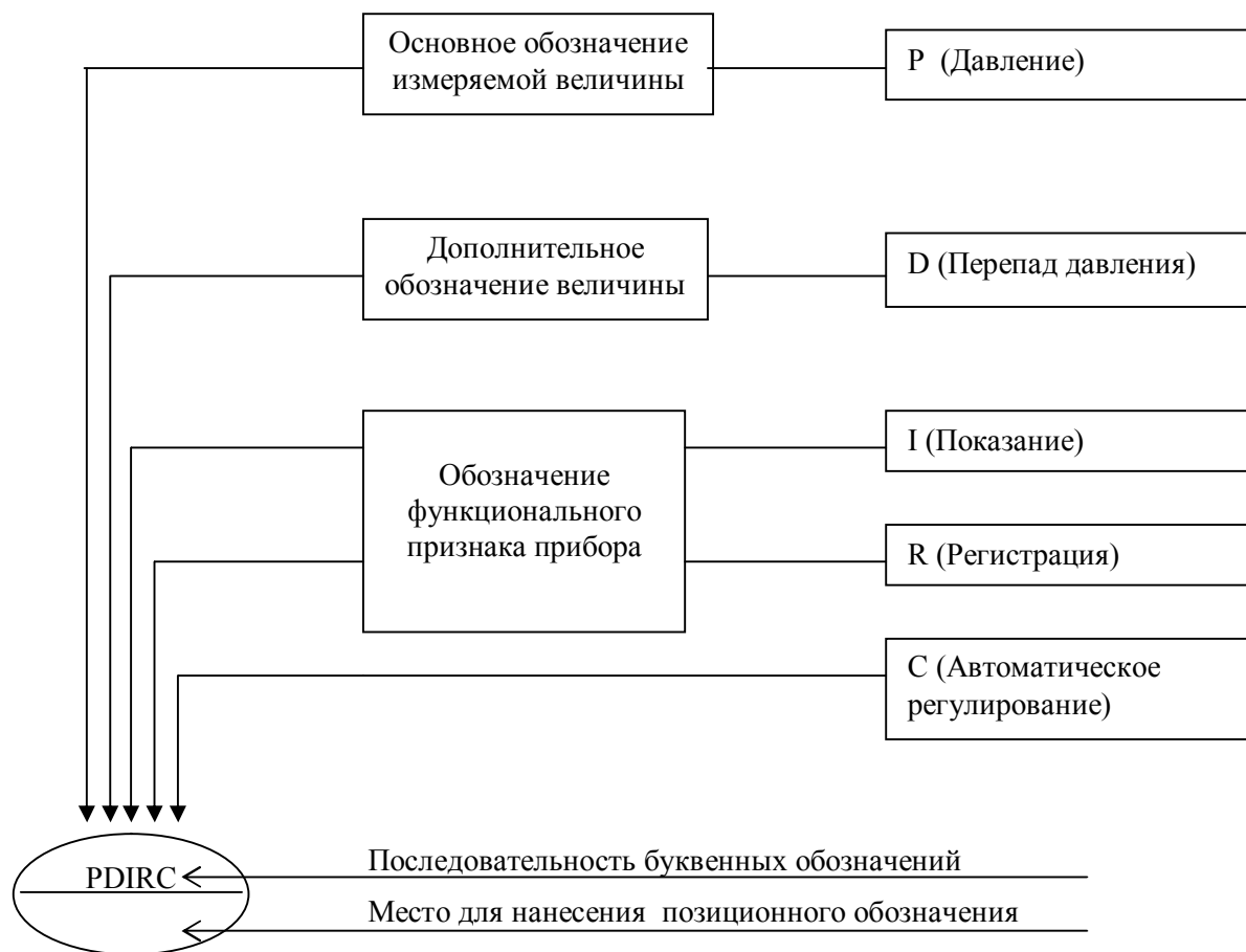
Рисунок 4.1 - Пример построения условного обозначения прибора
