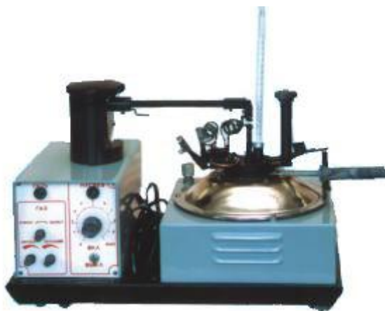
Рис.4. Аппарат ТВ3 для определения температуры вспышки в закрытом тигле
