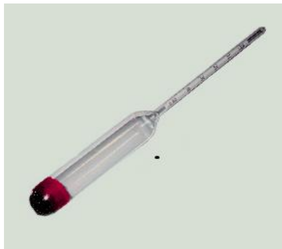
Рис.2. Прибор для определения плотности нефтепродуктов
