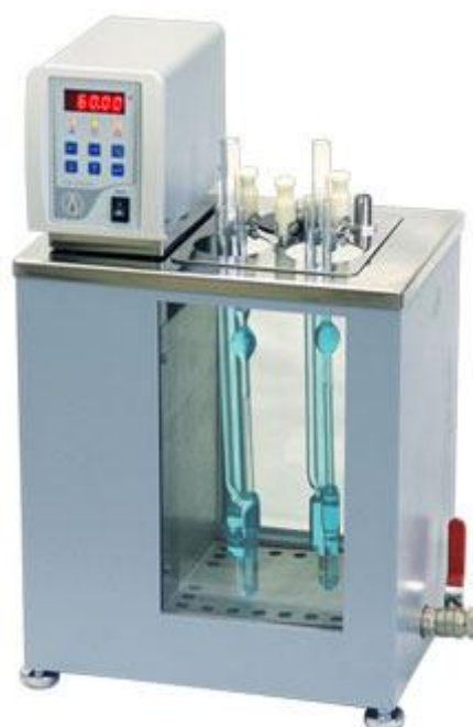
Рис. 3 Термостат жидкостной для поддержания температуры стеклянных вискозиметров при определении кинематической вязкости нефтепродуктов по ГОСТ 33-2000
